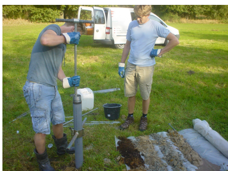
Freek Postema en studiegenoot Stefan (van Ir-Bureau Mug uit Leek) plaatsen een grondwaterbuis (filter 230-430 cm).
