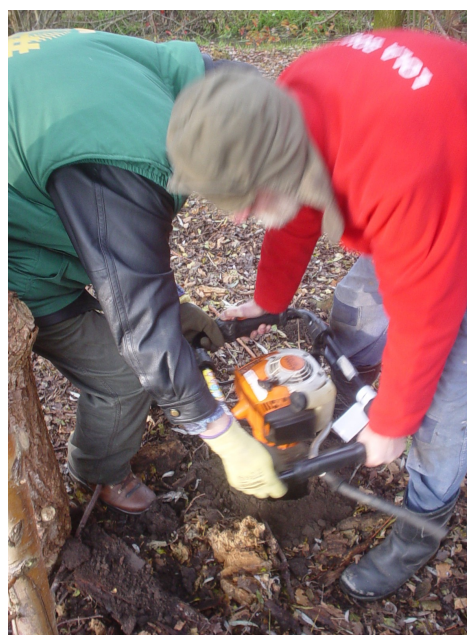
Gerrit Dijkstra en Klaas Frankes hanteren met vereende krachten de motor-grondboor bij de werkschuur.
